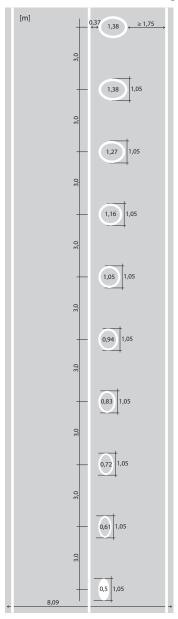
**Erläuterung:** Die Markierung richtet sich an Zweirad Fahrende. Sie hebt die für eine sichere Kurvendurchfahrt empfohlene Fahrlinie hervor. Zweirad Fahrenden wird empfohlen, rechts von der Kurvenmarkierung für Zweirad Fahrende zu fahren und diese auch nicht teilweise zu überfahren.
