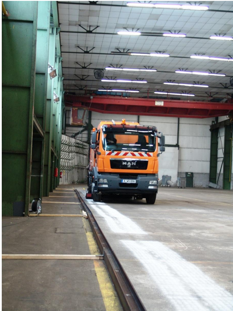
Testparkour präpariert für die Randsteinkehrung
