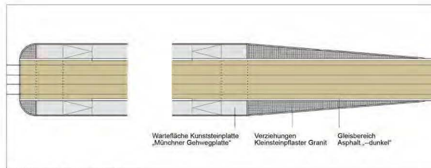
Gestaltungsprinzip befestigte Trasse
