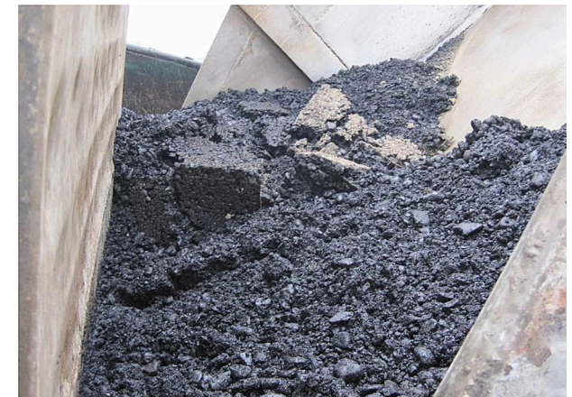
Bild 16: Für den Einbau nicht geeignetes Asphaltmischgut (Verunreinigungen)
