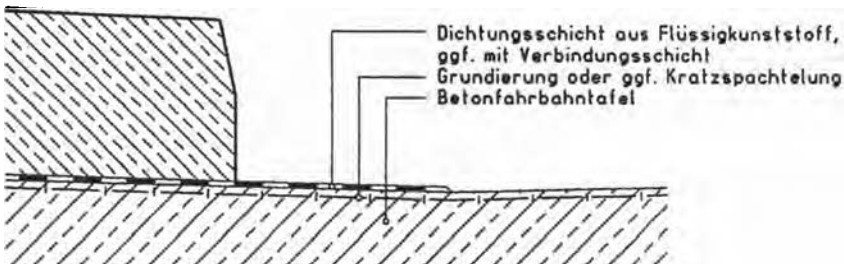
Bild 2: Belagsaufbau im Kappenbereich
